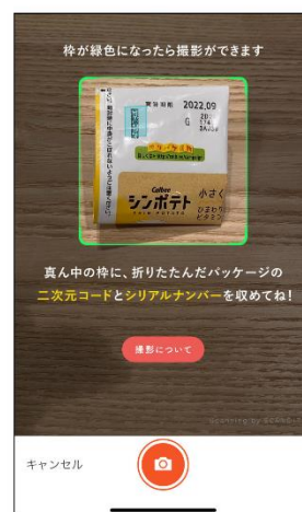
画像 2 : 正常に読み取れた「折りパケ」は、認識したDataMatrixが青色AR表示され、枠が緑色になる。
