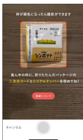
画像 1 : DataMatrixの読み取りが完了していない場合、枠が赤色で表示される。
