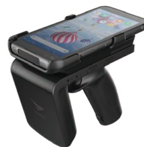
RFR901に搭載して高速、長距離読取
